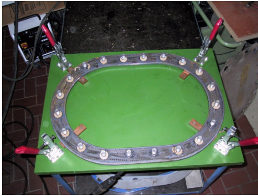
Vorrichtung für Bolzen RD20x35 auf Mannlochring schweißen
